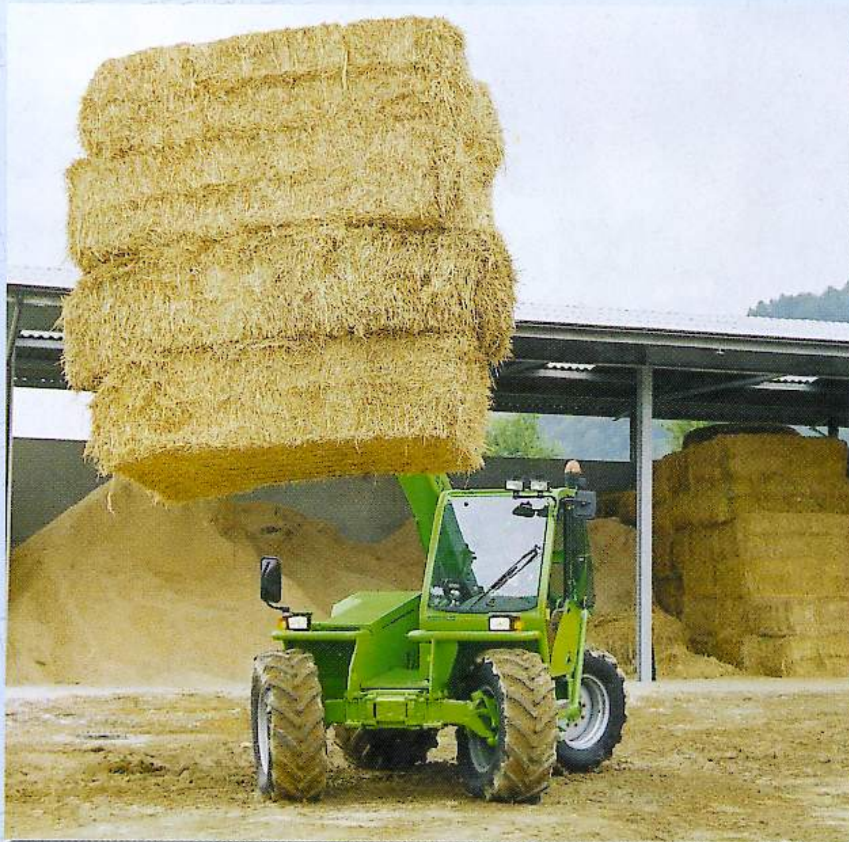
Annahme gemäß EN 1459/B: Der Lastschwerpunkt liegt 500 hinter den Gabelspitzen
